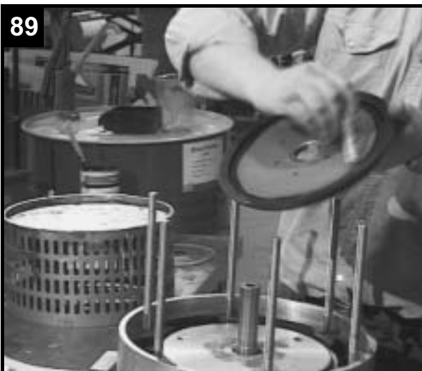
89 Lubricate impeller disc.
